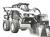
Pala meccanica (minipala) con tagliasfalto con fresa
